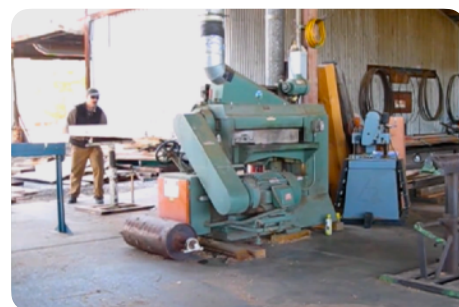
Bewerking en renovatie van een balk van GGH.
