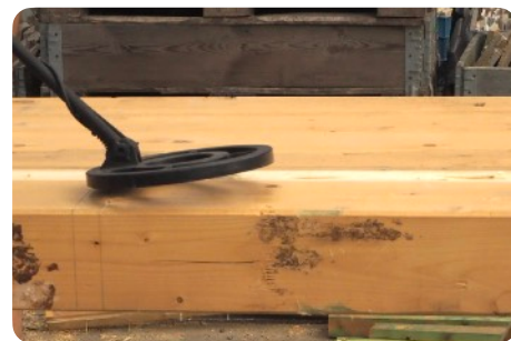
Inspectie met een metaaldetector
