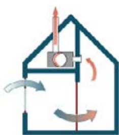
stelsel C: natuurlijke toevoer mechanische afvoer
