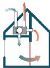
stelsel D mechanische toevoer mechanische afvoer
