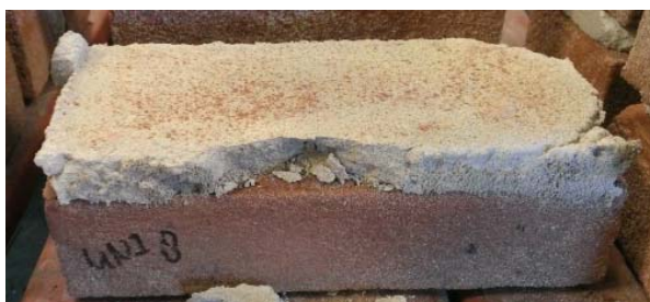
Bezweken mortel bij UNI 8 spouwanker
