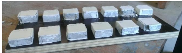
Figuur 87: Mortelprisma's (40*40) uit het metselwerk
