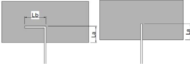
Figuur 117: Inlegdiepten twee typen spouwankers.
