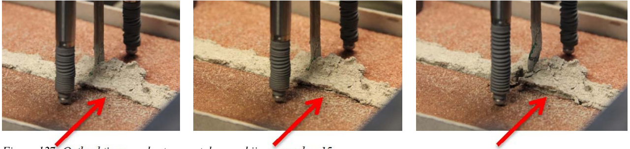
Figuur 127: Onthechting van de steen met de voeg bij spouwanker 15.
