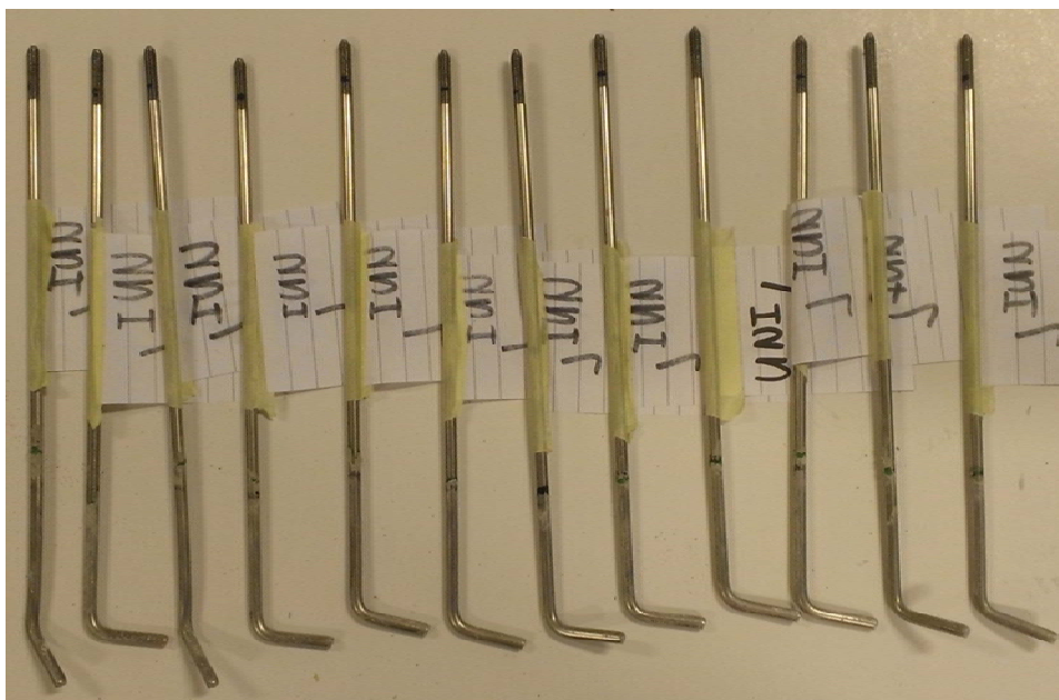
Figuur 134: De getrokken UNI-L spouwankers in M5-Mortel, de nummers 10 t/m 21.
