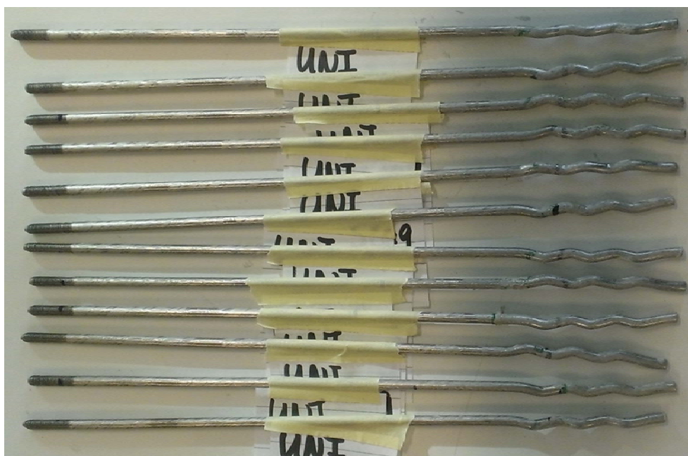
Figuur 123: De getrokken UNI275 spouwankers uit de M10-mortel, nummers 7 t/m 18.
