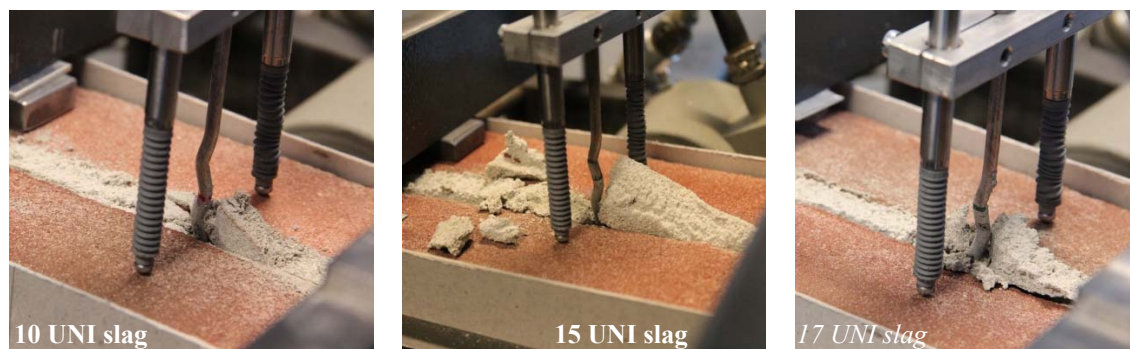
Figuur 69: Bezwijken van de voegen en het uittrekken van de UNI275 spouwankers gemetseld in M5-mortel nr. 10, 15 en 17.
