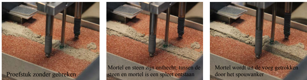
Figuur 135: Het onthechten van de steen met de mortel bij het uittrekken van het UNI-L spouwanker.
