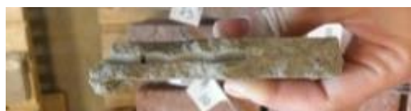
Figuur 85: Afdruk spouwanker in mortel voor bepaling inlegdiepte bij het UNI275 spouwanker nr. 21.
