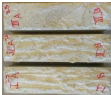
Figuur 86: Mortelprisma's (160*40) gemaakt in stalen malen
