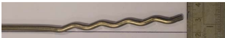
Figuur 46: De scheefstand van 10 mm die het spouwanker heeft voordat het ingemetseld wordt.
