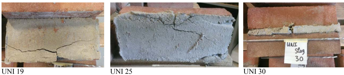
Figuur 122: Bezweken voegen, in drie verschillende proefstukken en begincondities.
