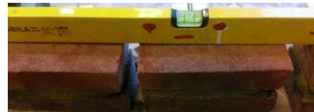
Figuur 51: Waterpas leggen van het proefstuk.
