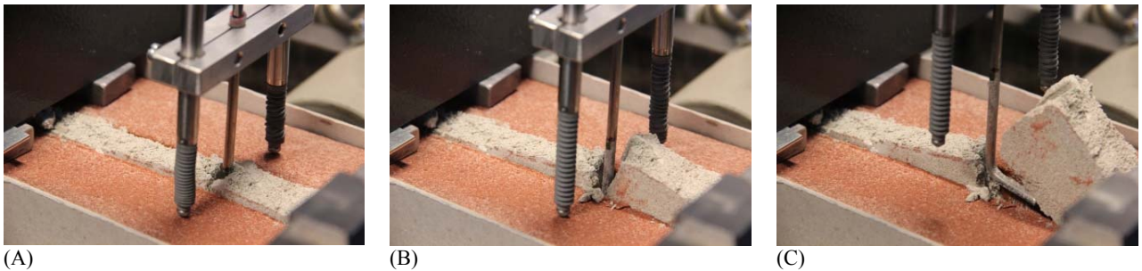
Figuur 130: Uittrekgedrag van het UNI-L spouwanker gemetseld in M5- of M10-mortel.
