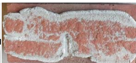
Figuur 82: Hechtoppervlak bij lijm-mortel
