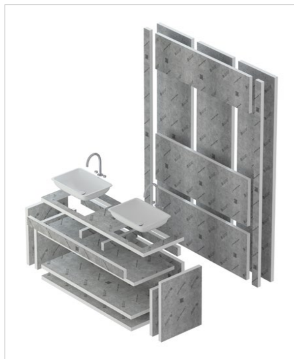
Creëren van een onderbouw voor wastafels
