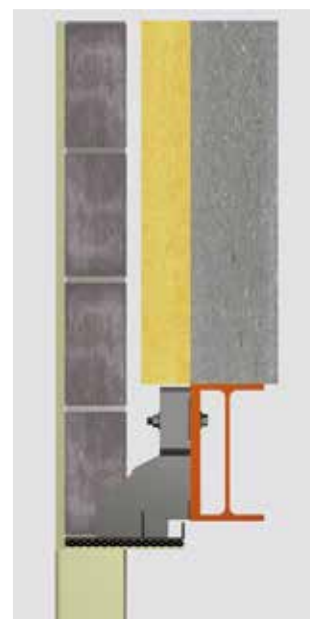
Strekmetaal gelast aan het hoekstaal om een goede hechting van de bepleistering te verkrijgen
