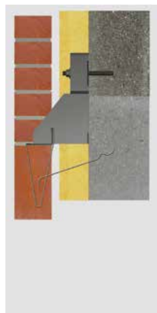
1 onderhangende steen, Ankrchim bevestiging in volle betonblokken of in gevulde betonblokken
